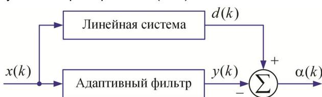
Рис. 1. Адаптивная идентификация линейной системы
