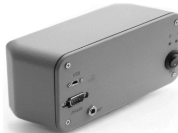
Рис. 1. Сверхширокополосный радиолокационный датчик наблюдения биомеханических характеристик человека
