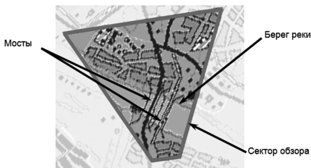
Рис. 2. Топографическая карта местности с наложенным на неё сектором радиолокационного обзора
