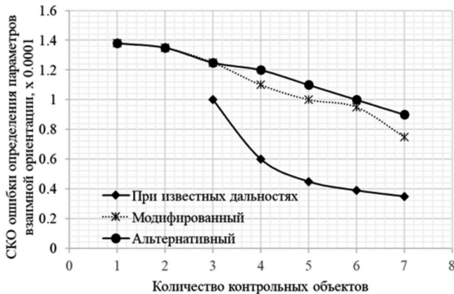
Рис. 8. Зависимость СКО оценок параметров взаимной ориентации от числа контрольных объектов при СКО ошибок координат ортов \sigma_a = 0,0005
