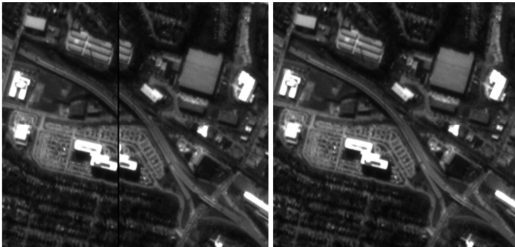
Рис. 1. Фрагменты исходных сканов и «сшитого» изображения от МКА «Аист-2Д» (виток 14655, стык изображений от 5 и 6-й ПЗС-матриц мультиспектрального оптико-электронного преобразователя)
