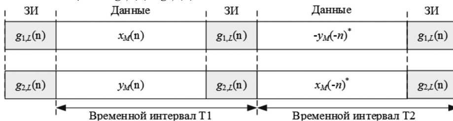
Рис. 5. Структура пространственно-временных потоков SC кадра
