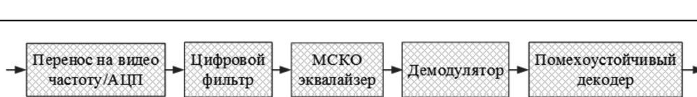
Рис. 3. Общая схема принимающего устройства для поля данных
