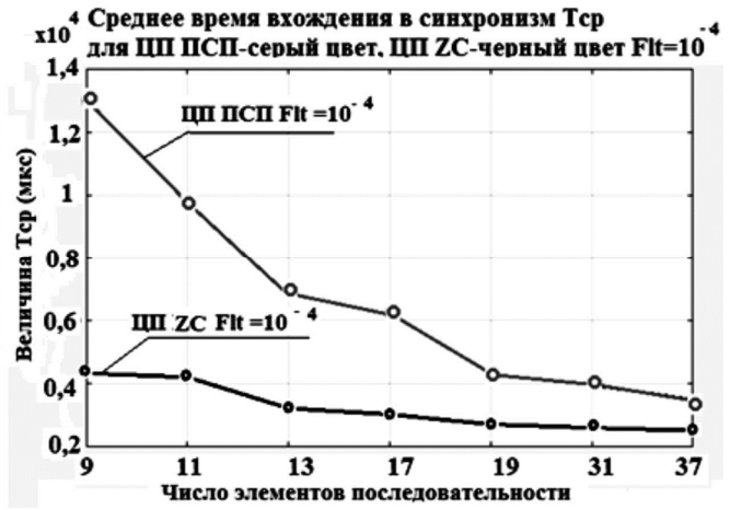
Рис. 1 а. График зависимости T_{cp} на этапе синхронизации по ЦП от числа элементов последовательности N = 9, 11, 13, 17, 19, 31, 37 для ЦП на ПСП – серый цвет(вверху) и коротких последовательностей ZC – черный цвет(внизу) при вероятностях ЛТ F = 10^{-3} (слева), F = 10^{-4} (справа)
