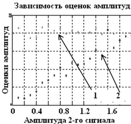
Рис. 12. Зависимость оценок амплитуд первого и второго сигналов в зависимости от линейно меняющейся амплитуды второго сигнала
