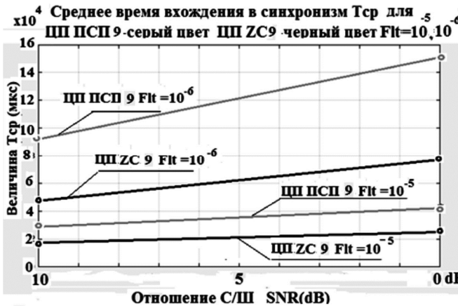
Рис. 6. Графики зависимости T cp от SNR(10dB, 0dB) для значений вероятности ЛТ F = 10 -5 , 10 -6 на этапе синхронизации по ЦП. Число элементов последовательностей N = 9 (слева), N = 17(справа) Серый цвет – графики T cp для ЦП, построенных на ПСП, черный цвет – для ЦП, построенных на последовательностях ZC
