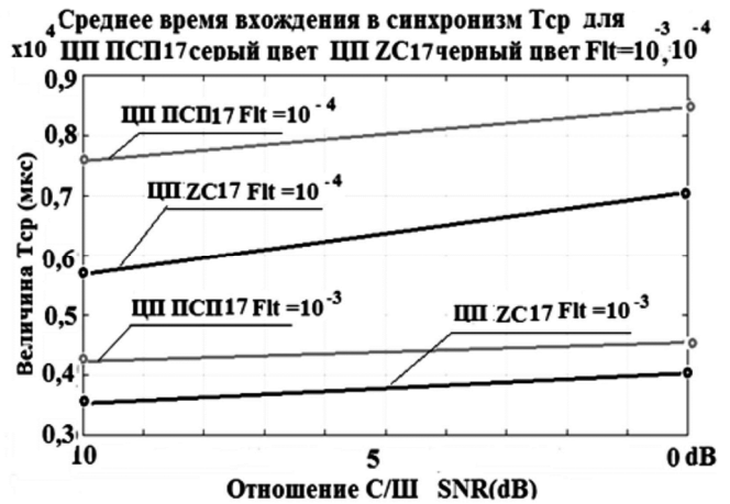
Рис. 5. Графики зависимости T cp от SNR(10 dB, 0 dB) для значений вероятности ЛТ F = 10 -3 , 10 -4 на этапе синхронизации по ЦП. Число элементов последовательностей N = 9 (слева), N = 17(справа) Серый цвет – графики T cp для ЦП, построенных на ПСП, черный цвет – для ЦП, построенных на последовательностях ZC
