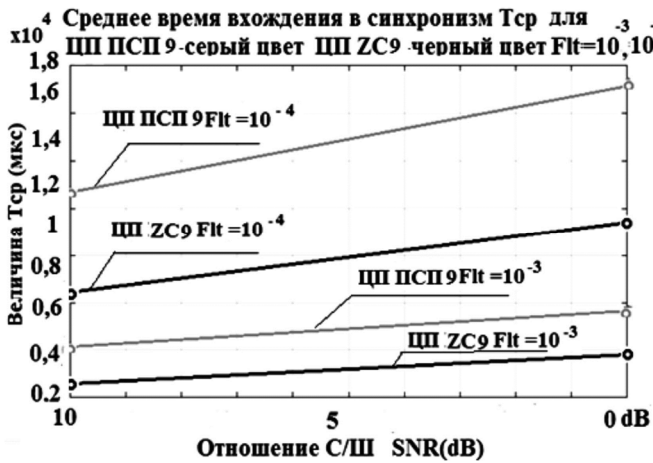
Рис. 5. Графики зависимости T cp от SNR(10 dB, 0 dB) для значений вероятности ЛТ F = 10 -3 , 10 -4 на этапе синхронизации по ЦП. Число элементов последовательностей N = 9 (слева), N = 17(справа) Серый цвет – графики T cp для ЦП, построенных на ПСП, черный цвет – для ЦП, построенных на последовательностях ZC
