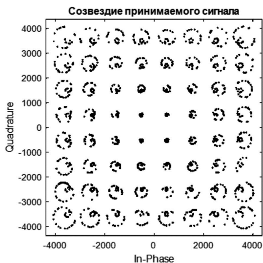
Рис. 6. Сигнально-кодовое созвездие принятого сигнала при наличии многолучевости
