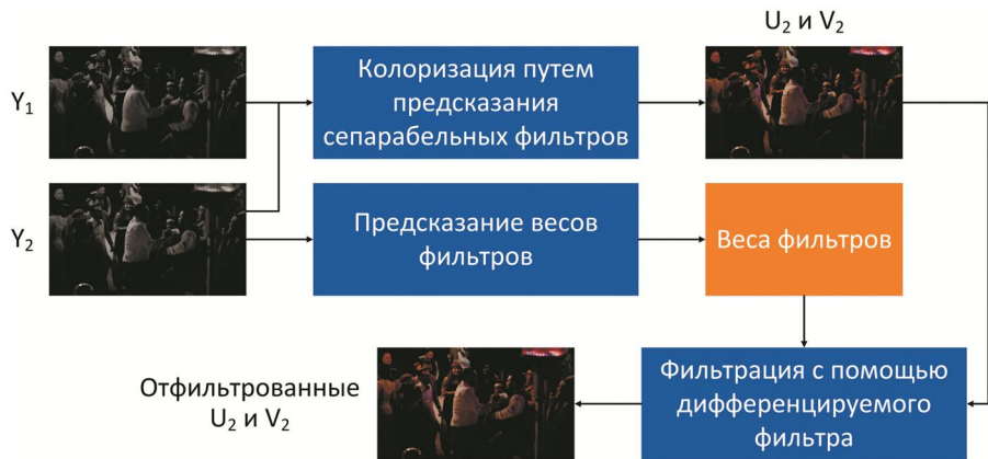
Рис. 5. Схема модифицированного метода, предсказывающего сепарабельные фильтры для распространения цвета с фильтрацией результата с помощью дифференцируемых фильтров
