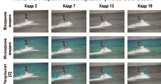
Рис. 2. Пример работы алгоритма [2] для колоризации видео при предоставлении цвета для первого кадра. Результат работы отчетливо показывает, что использование такого алгоритма без дополнительных данных для следующих кадров приводит к потере качества колоризации для этих кадров
