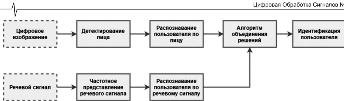
Рис. 1. Блок-схема мультимодальной биометрической системы идентификации личности
