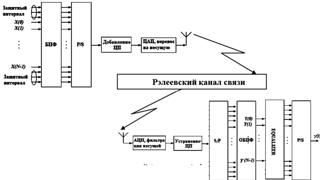
Рис. 2. Функциональная схема канала передачи – приема OFDM-символов
