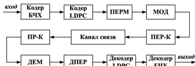
Рис. 1. Упрощенная схема передачи сигналов в спутниковой системе связи стандарта DVB-S2
