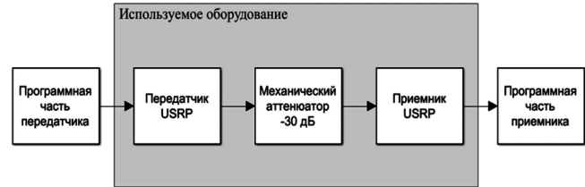
Рис. 2. Структурная схема исследуемой системы
