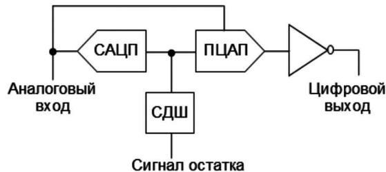
Рис. 9. Блок-схема конвейерной секции на основе ПЦАП: САЦП – секционный АЦП; СДШ – секционный дешифратор
