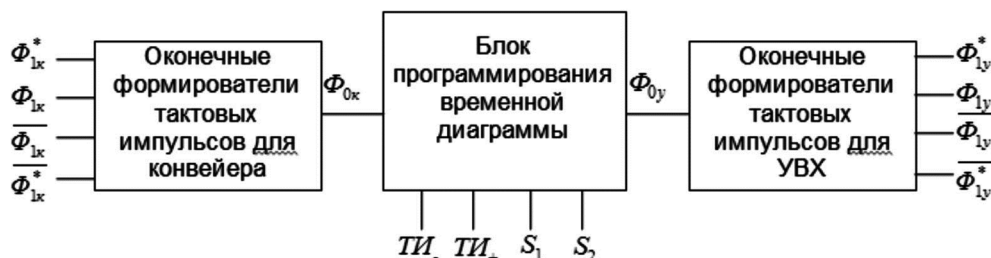
Рис. 10. Блок-схема формирования тактовых импульсов: ТИ_+, ТИ_- – входные тактовые импульсы;
