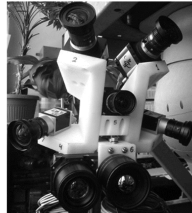
Рис. 3. Макет мультиспектральной распределенной панорамной системы: сверху – пять телевизионных камер, снизу по центру – камера длинноволнового инфракрасного (ИК) диапазона 8-14 мкм, в левом нижнем углу – камера коротковолнового ИК диапазона 0,9-1,7 мкм
