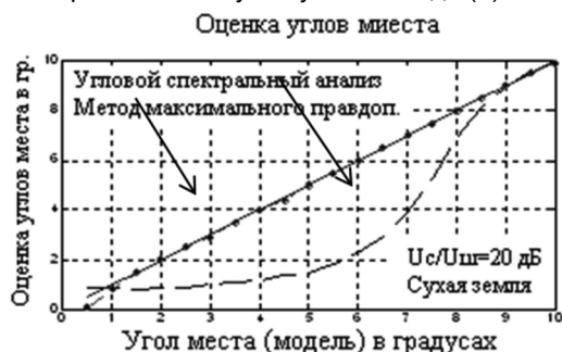
Рис. 7. Оценка углов места в области 0-10 градусов. Коэффициент корреляции меняется в пределах 0,99-0,22. Отношение сигнал/шум равно 20 дБ. Сухая земля
