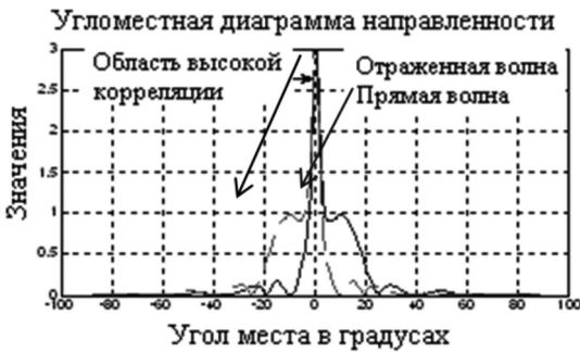
Рис. 3. Диаграммы направленности антенной системы по углу места. Малые углы места. Модельное значение угла места 10 градусов
