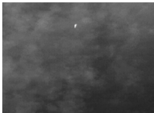
Рис. 1. Результат \gamma - фильтрации цифрового изображения БЛА на фоне высоко кучевой облачности ( \gamma=2,5 )
