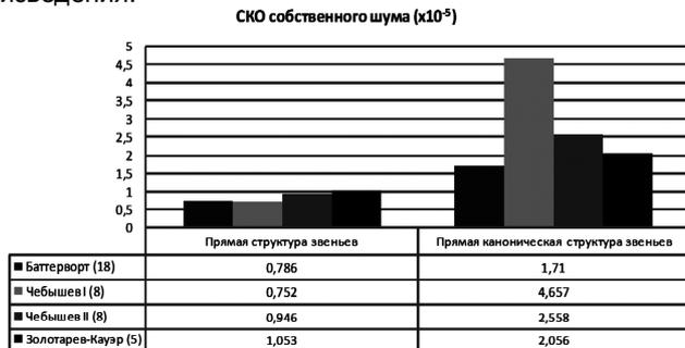
Рис. 12. СКО собственного шума БИХ-фильтров с прямой и прямой канонической структурой звеньев
