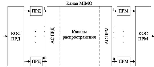
Рис. 1. Укрупненная схема фрагмента радиолинии с MIMO
