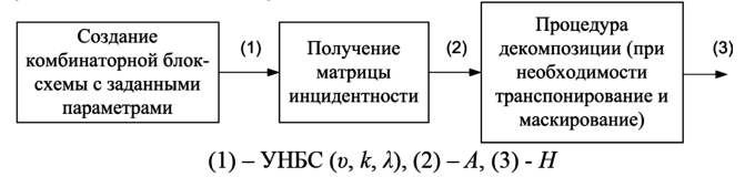
Рис. 2. Обобщённый алгоритм синтеза LDPC кодов на основе комбинаторных блок-схем
