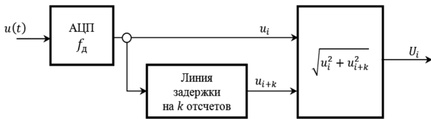
Рис. 4. Функциональная схема цифрового способа выделения огибающей
