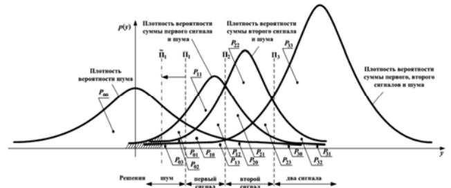
Рис. 1. Пояснение к формированию элементов матрицы \mathbf{P} , характеризующей качество полного разрешения двух сигналов
