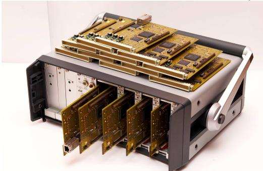
Рис.10. Комплекс верификации с наращиваемой логической емкостью.
