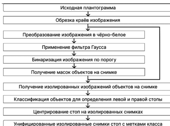
Рис. 2. Структурно-логическая схема работы алгоритма предобработки плантограмм
