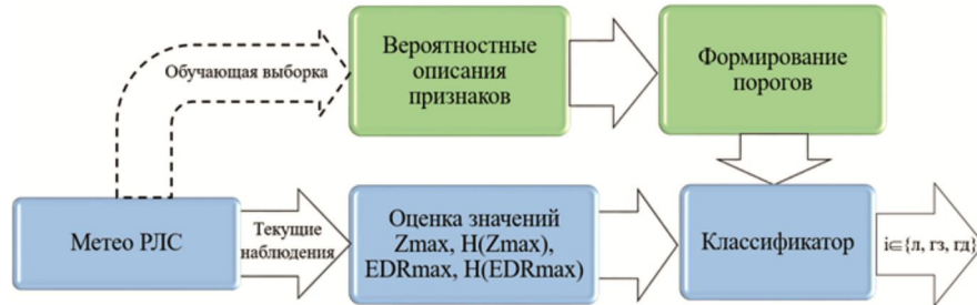
Рис. 12. Структура алгоритма радиолокационной классификации опасных метеоявлений кучево-дождевой облачности на основании байесовского подхода
