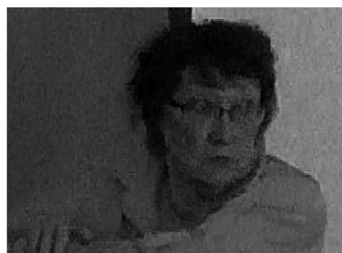
Рис. 4. Видеокادر с ВЧ шумом, полученный при низкой освещенности
