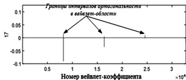
Рис. 5. Вейвлет-коэффициенты гармонического вейвлет-преобразования сигнала для 17-го уровня вейвлет-разложения
