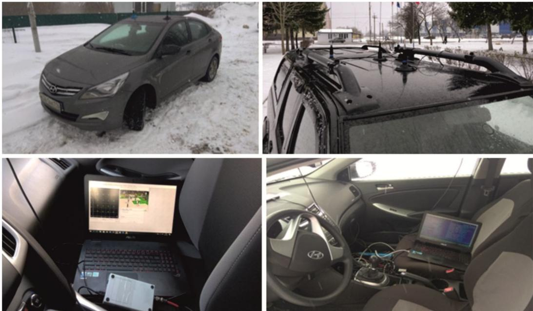
Рис. 7. Автомашина с установленными антеннами, приемник внутри автомашины
