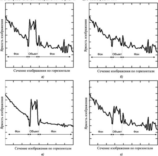
Рис. 1. Иллюстрация влияния корреляции яркостей между двумя спектрозональными изображениями (а) и (б) на возможность повышения заметности объектов на едином комплексированном изображении при оптимальных (в) и неоптимальных (а) параметрах синтеза
