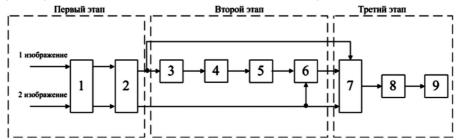
Рис. 2. Блок-схема алгоритма комплексирования двух разноспектральных изображений
