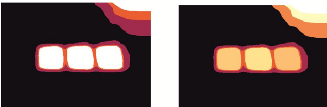
Рис. 4. Тепловое изображение в цвете (по трем уровням) после сегментации в матрице Y_2 и тепловое изображение в сегментах матрицы Y_1 , полученные алгоритмом 1 без фильтра Винера
