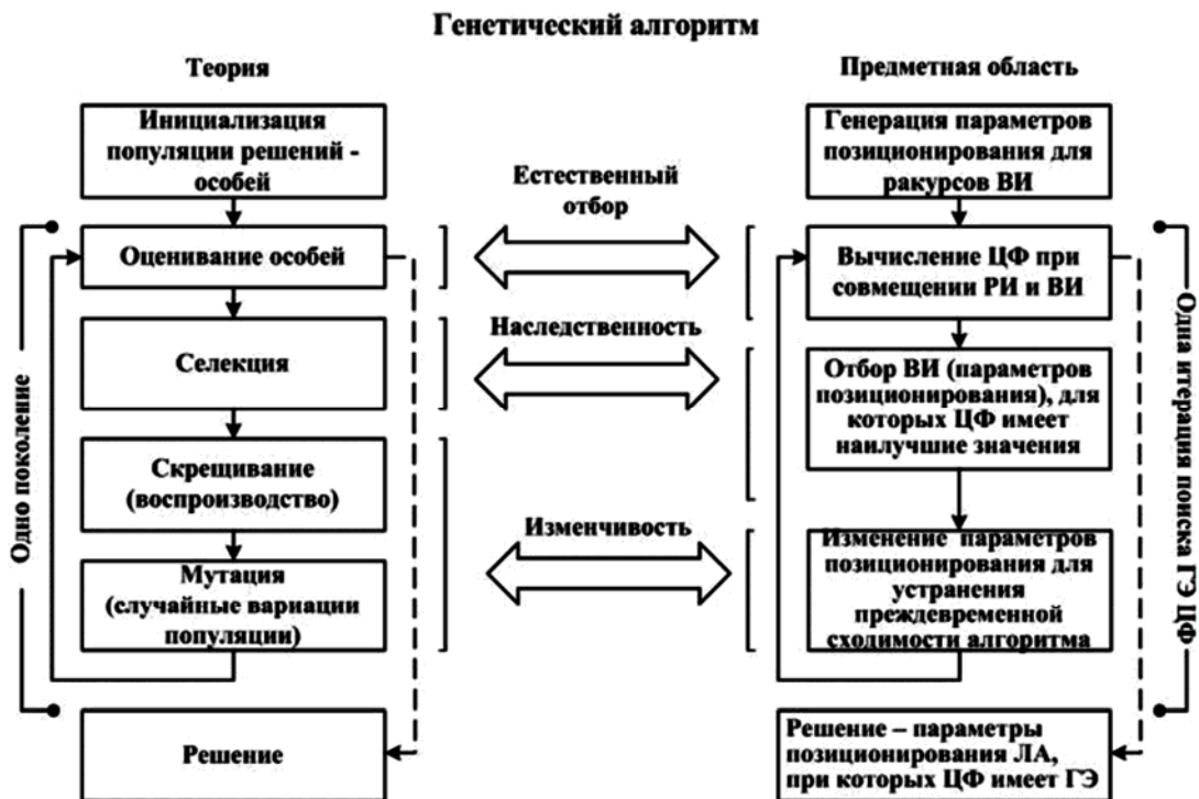
Рис. 6. Общая схема ГА
