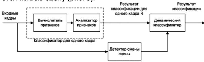
Рис. 5. Структура классификатора для видеопоследовательности
