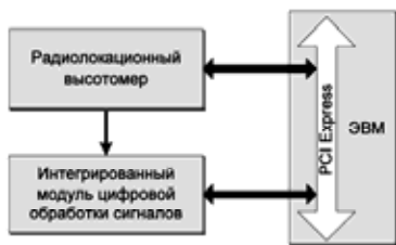
Рис. 5. Структурная схема системы корреляционно-экстремальной обработки
