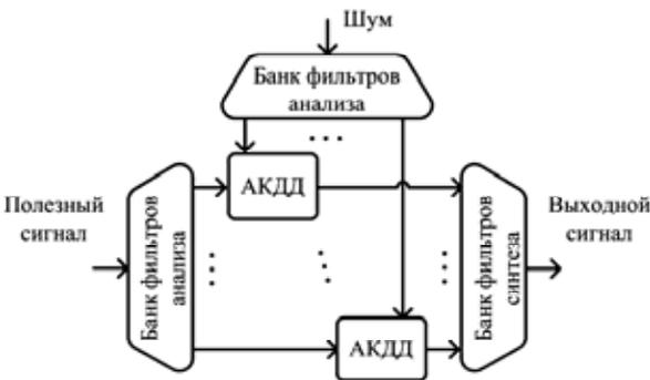
Рис. 4. Схема обработки сигнала для повышения качества его воспроизведения в шумовой обстановке
