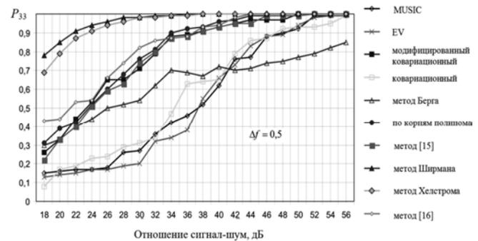
Рис. 5. Оценки вероятности  $P_{33}$  полного разрешения двух сигналов для методов спектрального анализа.
