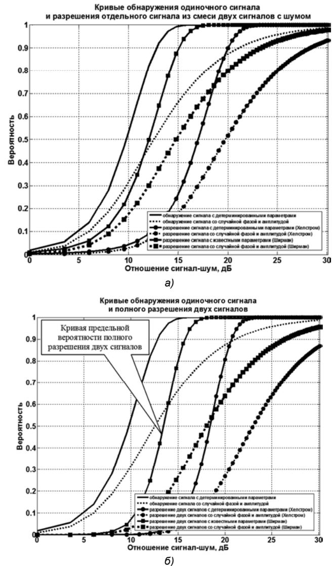
Рис. 2. Оценки эффективности методов сверхрэлеевского разрешения Я. Ширмана и К. Хелстрема при вероятности ложной тревоги  $F=0,001$  и коэффициенте корреляции сигналов  $\rho=0,9$
