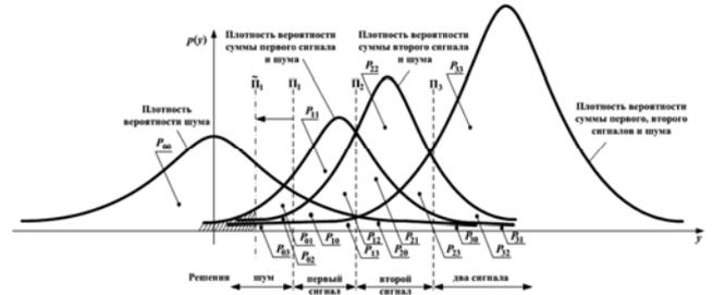
Рис. 1. Пояснение к формированию элементов матрицы  $\mathbf{P}$ , характеризующей качество полного разрешения двух сигналов
