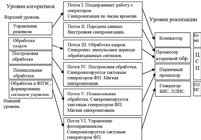
Рис. 6. Схема многоуровневых алгоритмов, потоков команд и их реализации
