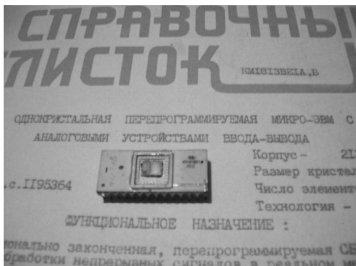
Рис. 1. Первый отечественный программируемый сигнальный процессор KM1813BE1 на фоне справочного листа с его описанием
