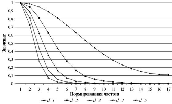
Рис. 2 Амплитудный спектр одиночной импульсной функции (14), приближённой сплайном степени  $m=3$ .
