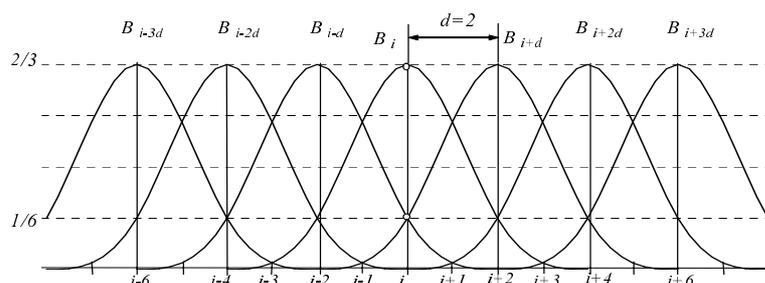
Рис. 1. Множество базисных кубических  $B$ -сплайнов при  $d=2$ .
