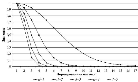
Рис. 3 Амплитудный спектр одиночной импульсной функции (14), приближённой сплайном степени  $m=5$ .
