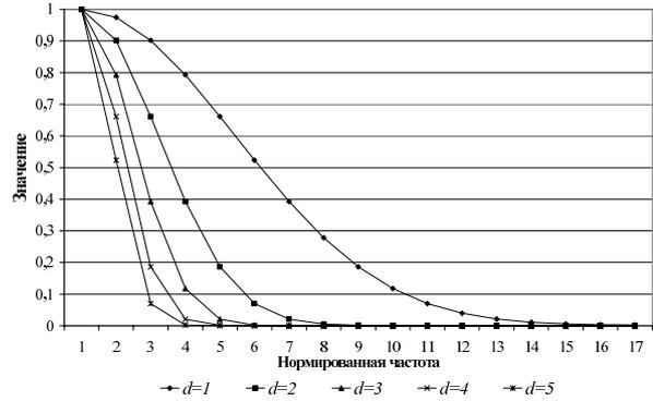
Рис. 4 Амплитудный спектр одиночной импульсной функции (14), приближённой сплайном степени  $m=7$ .
