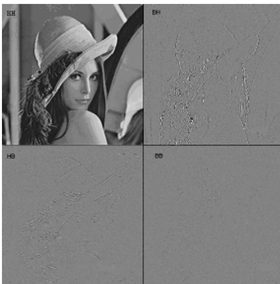
Рис. 3. Распределение вейвлет-коэффициентов по изображению Lenna, разбиение на 4 и 6 компонент соответственно. Величина НЧ-коэффициентов уменьшена в 2 раза, величина ВЧ-коэффициентов, расположенных на уровне серого, увеличена в 4 раза.
