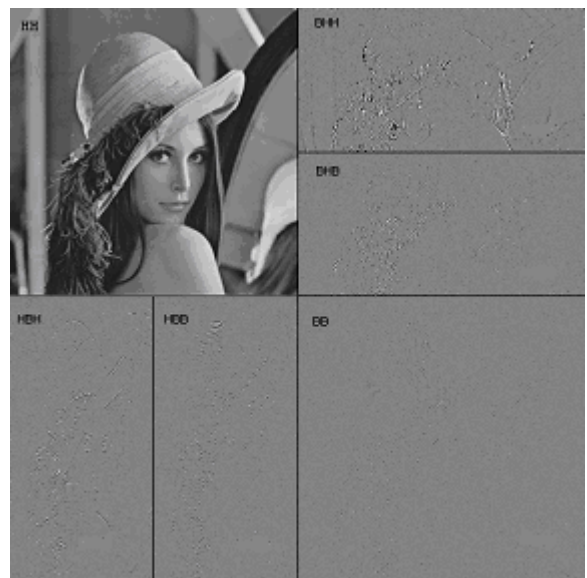
Рис. 3. Распределение вейвлет-коэффициентов по изображению Lenna, разбиение на 4 и 6 компонент соответственно. Величина НЧ-коэффициентов уменьшена в 2 раза, величина ВЧ-коэффициентов, расположенных на уровне серого, увеличена в 4 раза.
